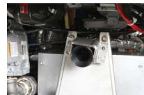
図2: 溶解ユニットをキャビネットの中にスライドさせます。
