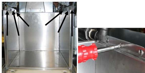
図4: 6個のPhillipsプラスねじを使用して溶解ユニットをレールに取り付けます。
