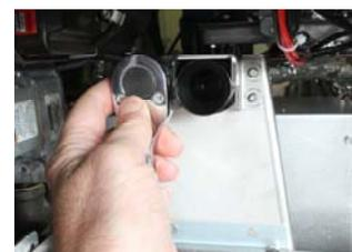
図3: サクシジョンアセンブリを溶解ユニットに取り付けます。
